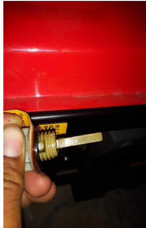
Kiểm tra nhớt bằng que thăm nhớt.
